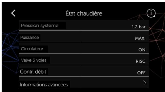
**Pression du système** : indique la pression réelle du système lue par le transducteur, placé sur la livraison du système de produit.
