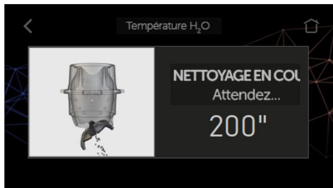
Ensuite, la vis à granulés est activée. Le nombre exprimé en secondes indique le temps de rotation de la vis pendant la phase de chargement. Passé ce délai, la vis s'arrête automatiquement.
